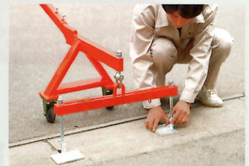
④引っ掛け棒を手掛け部の穴へ挿入し、フタの下まで下りてくることを確認後、振れ止板を下げ、棒を90度回転させる。
