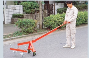
②組立後移動の仕方。 引っ掛け棒を移動用フックに掛けて運ぶと楽です。
