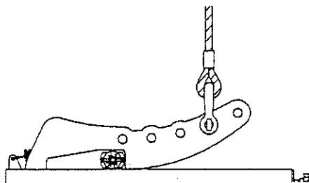
注：吊ワイヤーは安全使用荷重のものを御使用下さい。又、2点吊ワイヤーは左右均等の長さのものを使用し、片側の長さ(A)が吊具設置巾(B)の2倍以上、(C)が30度以内になる事を確認、厳守して下さい。
