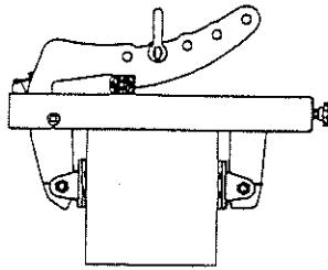
吊上げは垂直方向に行い、5~10cm程度吊上げたところで下記事項の確認を行って下さい。
