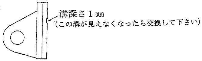
\* 御使用前後は吊具(本体)に変形、破損等がないか必ず確認を行って下さい。
